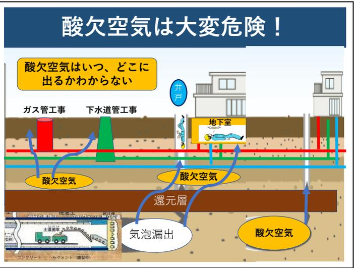
1960～70年代に圧気工法原因の酸欠死亡事故が多発
